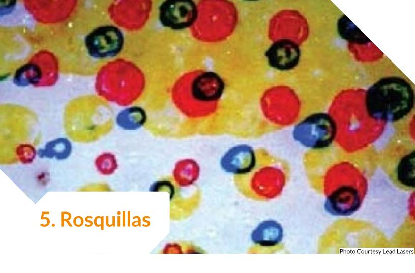
Síntomas: Los puntos de la trama en la impresión aparecen borrosos y distorsionados.
