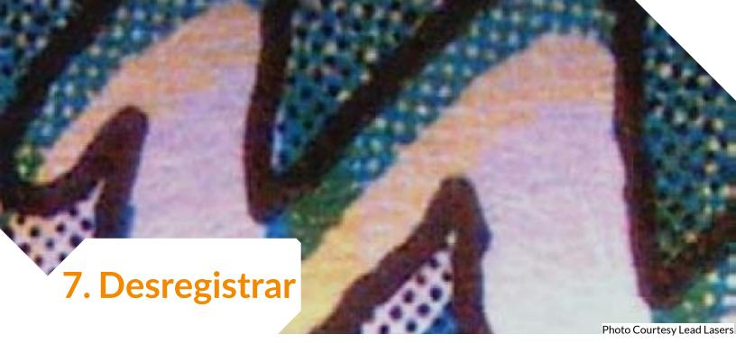
Síntomas: Este problema común de impresión flexográfica se produce cuando los colores no se posicionan correctamente, lo que hace que la imagen impresa se vuelva borrosa o incluso distorsionada.
